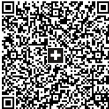
Illustration 12: Swiss QR Code avec croix suisse comme caractéristique d'identification (pas à l'échelle)
